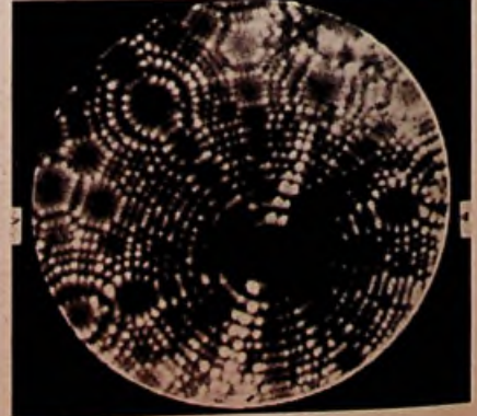
Afb. 3 - Als afb. 2, doch met argongas opgenomen. Optimale afbeeldingsspanning 4,3 kV (1,9 V/A).
